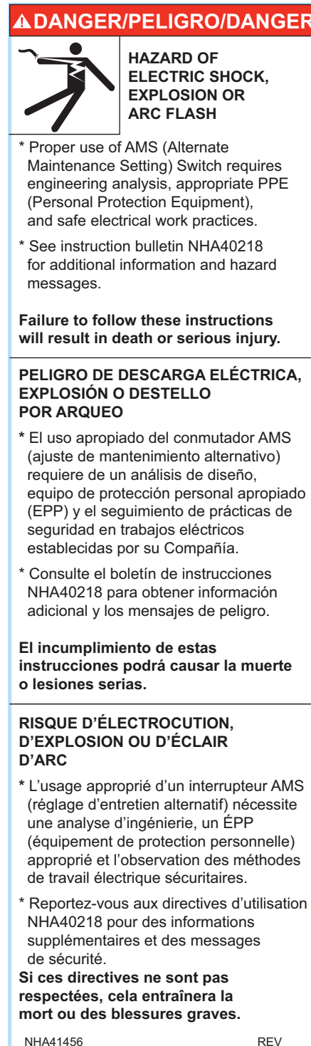
Figure 7 : Étiquette pour l'option d'interrupteur AMS à distance
