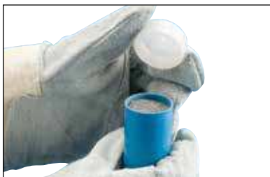
Fig. 19 Remove the lid over the mold crucible.
