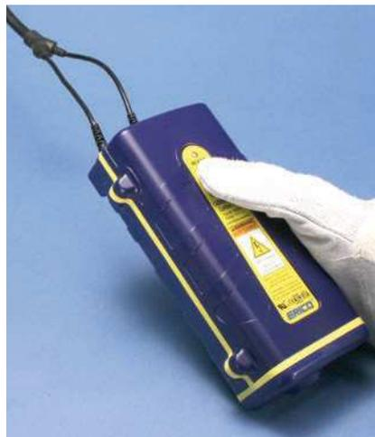
**Schritt 4:** Halten Sie den Startknopf gedrückt. Gießtiegel nach 10 Sekunden öffnen.
