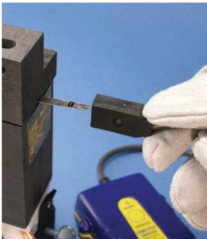
**Schritt 3:** Schließen Sie die Abdeckung und schließen Sie die Cadweld Plus-Steuereinheit an.
