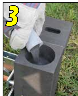
3 Pour powder into crucible.
