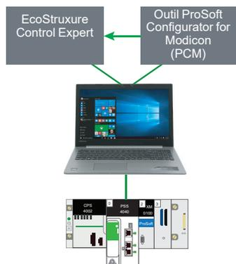
Vue générale du système avec le module PROFIBUS et les ateliers logiciel associés
