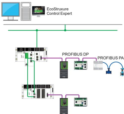
Architecture standard avec utilisation du module **PMEPXM0100** dans le rack local et le rack déporté
