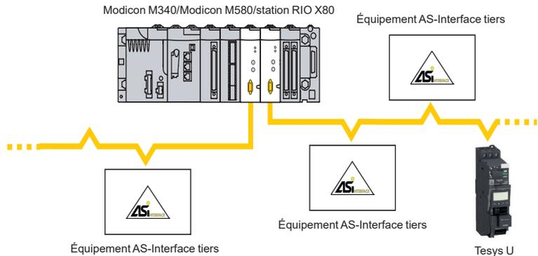
Le système de câblage AS-Interface est composé d'une station serveur (modules Modicon X80) et de stations clientes. Le serveur supportant le profil AS-Interface interroge tour à tour les équipements connectés sur la ligne AS-Interface et stocke les informations (états des capteurs/actionneurs, état de fonctionnement des équipements) dans la mémoire de l'automate. La gestion de la communication sur la ligne AS-Interface est totalement transparente vis-à-vis du programme application automate.
