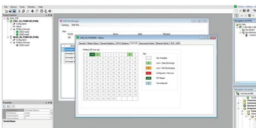
Surveillance en temps réel de l'état du module PROFIBUS DP
