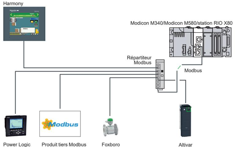
Le bus est composé d'une station client et de stations serveurs. Seule la station client peut être à l'initiative de l'échange (la communication directe entre stations serveurs n'est pas réalisable). Deux mécanismes d'échange sont possibles :
