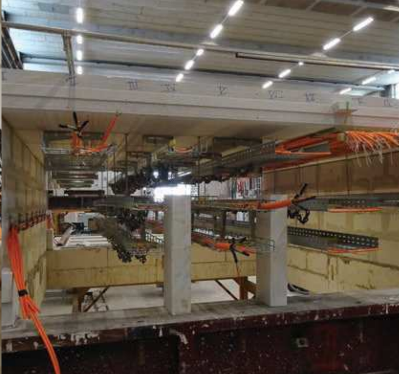
Bilder vom Brandversuch für UTS, PKM, CT & Teleskopische Montageschiene mit Rod Lock vor der Durchführung
