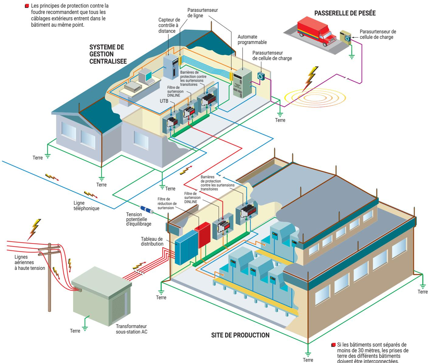
Ce Plan de protection à six points s'applique à un site de fabrication. Les principes de protection contre la surtension et les surtensions transitoires s'appliquent à la totalité d'un site plutôt qu'à différentes pièces d'équipement.
