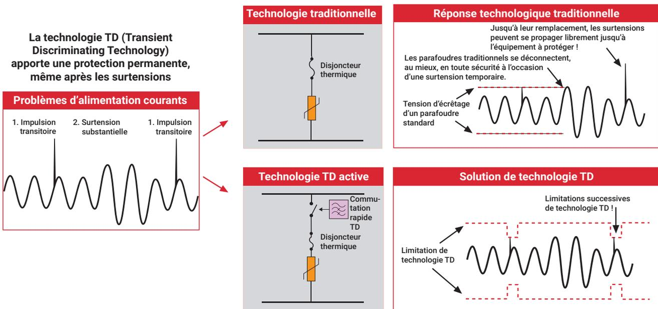
La technologie TD autorise efficacement le parafoudre à avoir deux niveaux d'écrêtage, un bien au-dessus du pic de la tension temporaire TOV (jusqu'à deux fois sa tension nominale de fonctionnement !), et le deuxième bien inférieur, pour limiter efficacement et en souplesse les phénomènes transitoires provoqués par la foudre.
