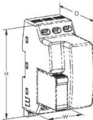
La gamme de filtres de protection contre les surtensions transitoires nVent ERICO Critec (TSF) est homologuée UL et conforme IEC. Elle représente une solution de faible encombrement et d'entretien facile des automates programmables, des systèmes SCADA, des centres de commande de moteurs et autres systèmes de contrôle de procédé.
