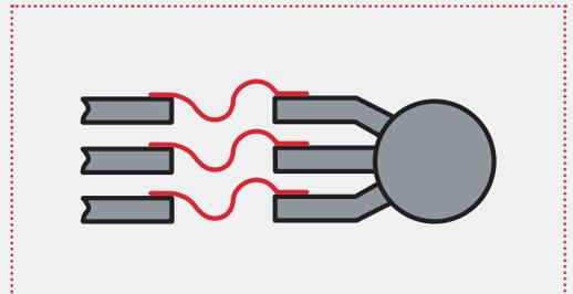
Motor-, Generator- oder Transformatoranschlüsse zu Stromschienensystemen
