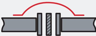
Erdungs-/Masseanschluß (Beispiel: Pipeline)
