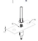
Werkstoff: Stahl; Zinklegierung; Polypropylen Oberfläche: elektrolytische Verzinkung Sicherheitsfaktor bei statischer Last: 5:1 Konform mit: SMACNA HVAC-DCS
