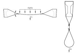
Werkstoff: Stahl; Zinklegierung; Polypropylen Oberfläche: elektrolytische Verzinkung; Feuerverzinkt Stahlseil Durchmesser: 6 mm
