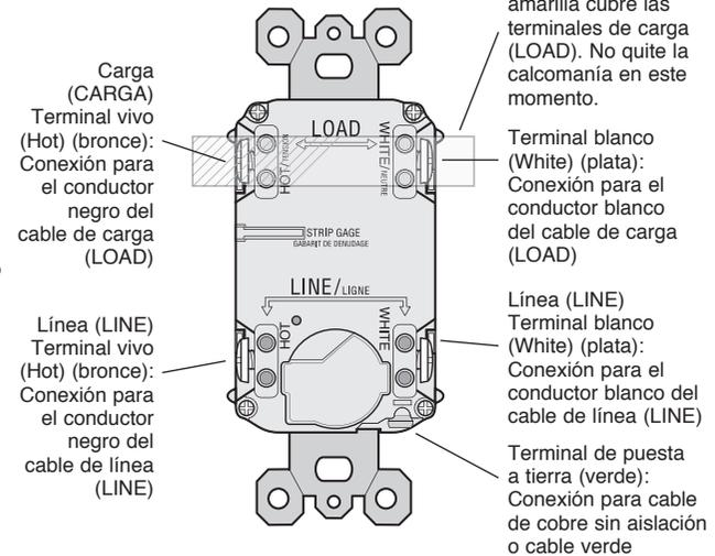
(ver el diagrama que se muestra a continuación). Siga los pasos a hasta e del procedimiento de la derecha.
