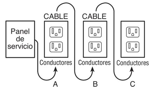
Colocar el interruptor diferencial en la posición A también protegerá a los receptáculos B y C "del lado de la carga". En cambio, colocar el interruptor diferencial en la posición C no brindará protección a los receptáculos A ni B. Recuerde que los receptáculos A, B y C pueden estar en habitaciones distintas.
