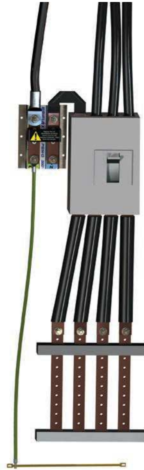
Spezielles TN-S Netzteil
