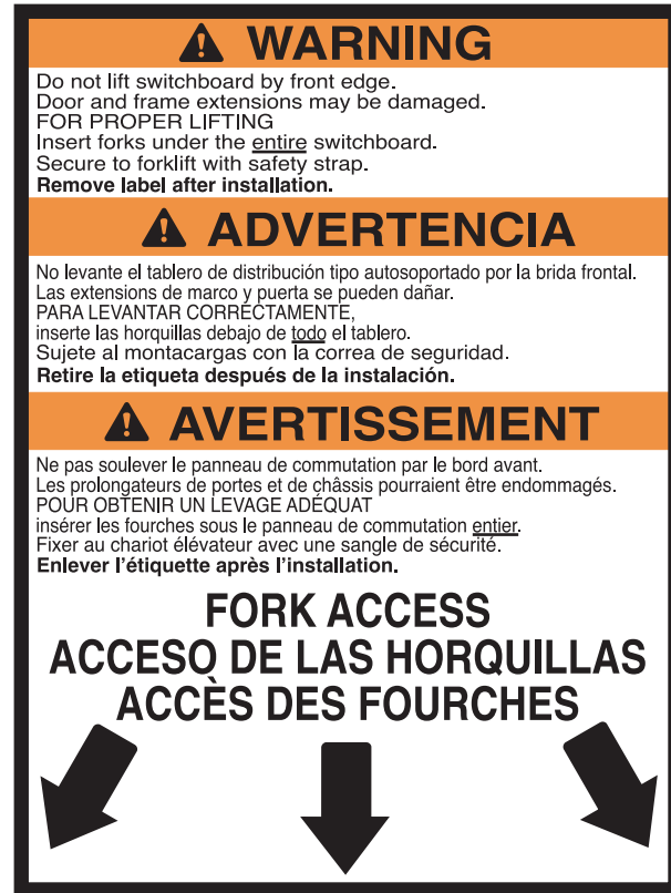
Figura 4: Etiqueta de instrucciones de advertencia – Tableros de distribución a prueba de lluvia
