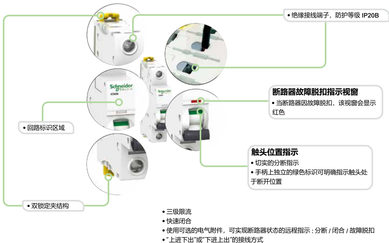
iC65N 断路器 (符合 GB/T 14048/IEC/EN 60947-2)
