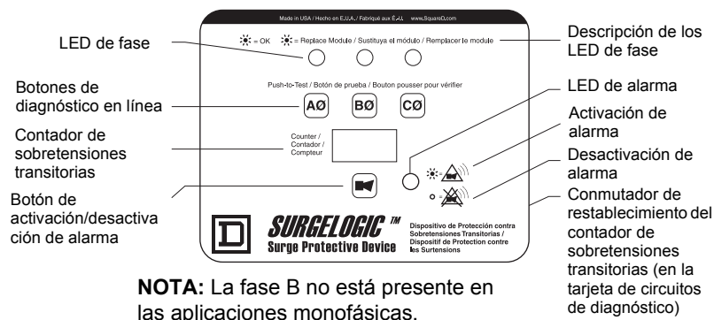
Figura 9: Pantalla de diagnóstico de tres fases con contador de sobretensiones transitorias
