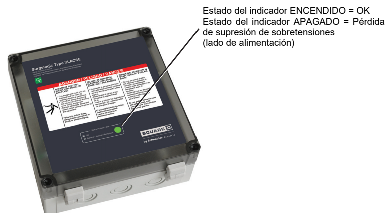
Figura 4: Funcionamiento de diagnóstico tipo SLACSE
