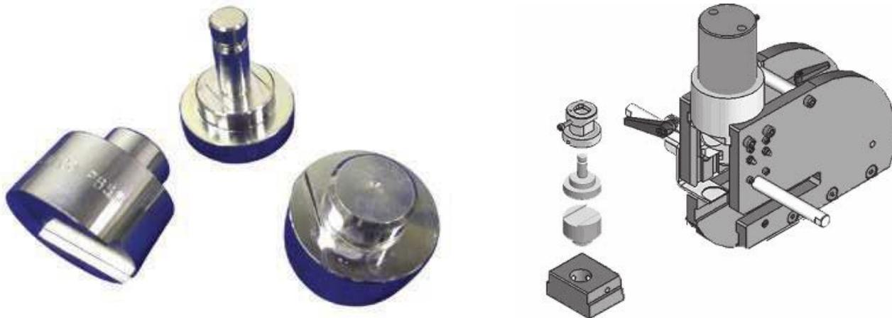
Mit diesem Paket können die Kabelschuhe PB16, PB25 und PB50 am Erdungsband befestigt werden. Hierzu benötigt man eine hydraulische Stanze um eigene Erdungsbänder herstellen zu können.
