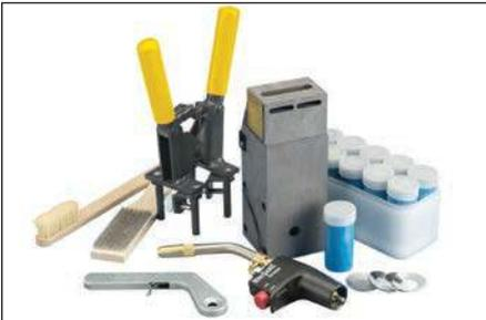
**Fig. 2** – Rassemblez les matériaux et l'équipement appropriés pour le type de connexion que vous effectuez. Le système Cadweld typique nécessite un moule en graphite, une pince à attache, un métal d'apport, une brosse à poils naturels pour le nettoyage des moules, une brosse métallique pour le nettoyage/la préparation des conducteurs, un allumeur à flint et une torche au propane.
