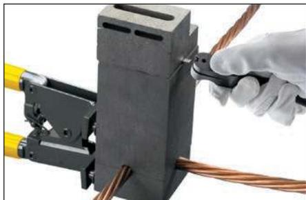
**Fig. 18** – Placer la bande d'allumage dans le connecteur du boîtier de commande. Retirer ou protéger des risques d'incendie à proximité immédiate du raccordement.
