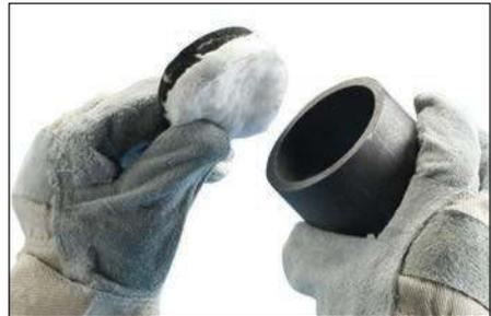
**Fig. 14** – Chaque boîtier Exolon contient 2 filtres pour une connexion à faible émission. Insérer les filtres en céramique blanche et graphite noir dans le couvercle du moule. (Les filtres doivent être changés toutes les 4 connexions.)
