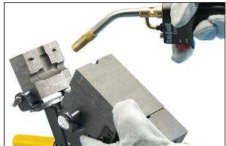
**Fig. 10** – Le graphite absorbe l'humidité. Allumer le chalumeau au propane et sécher soigneusement l'intérieur du moule des deux côtés, en chauffant le moule à environ 120 degrés Celsius (250 degrés Fahrenheit).
