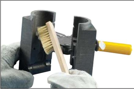
**Fig. 30** – Les moules en graphite Cadweld Exolon ont une durée d'environ 50 connexions. Utiliser un chiffon en coton doux ou une brosse à poils doux (nVent ERICO, pièce n° T394 pour nettoyer l'intérieur de la cavité et du couvercle du moule ; retirer toute scorie restante de la réaction exothermique.
