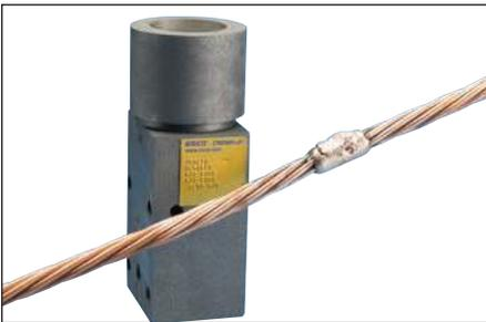
**Fig. 31** – Prêt à effectuer une autre connexion Cadweld.
