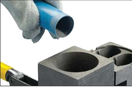
**Fig. 22** – Verser de  $\frac{1}{4}$  à  $\frac{1}{2}$  du matériau de démarrage sur le métal d'apport dans le creuset du moule.
