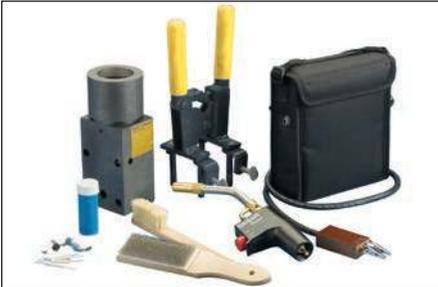
**Fig. 2** – Préparez les matériaux et l'équipement appropriés pour le type de connexion que vous effectuez. Le système Cadweld Exolon nécessite un moule en graphite Cadweld Exolon, une attache à poignée, un métal d'apport, une brosse métallique pour le nettoyage/la préparation des conducteurs, un bloc-batterie et une torche au propane.
