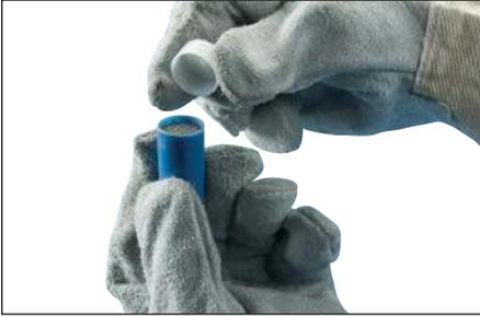
**Fig. 10** – Ensuite, prenez le tube du métal d'apport inclus dans l'emballage Cadweld One Shot et retirez le couvercle par-dessus au-dessus du creuset.
