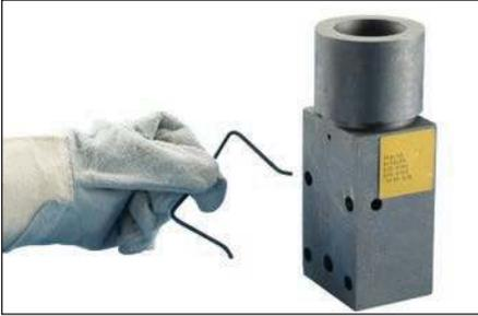
**Fig. 5** – Retirer le petit support métallique qui est utilisé pour maintenir temporairement le moule ensemble avant de l'utiliser. Mettre le support de côté.
