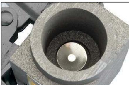
**Fig. 19** – S'assurer que le disque en acier est correctement installé.
