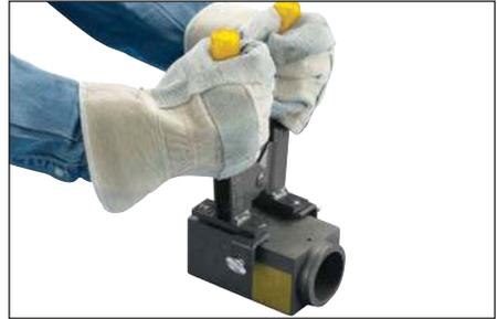
**Fig. 9** – Si le moule n'est pas correctement étanche, effectuer des ajustements pour l'attache de la poignée.
