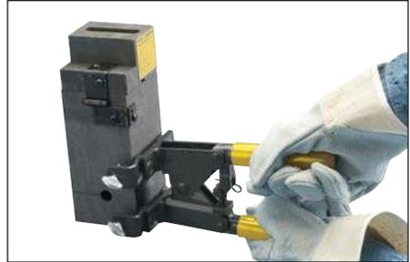
**Fig. 8** – Fermer les poignées pour verrouiller fermement le moule. Vérifier que le moule est muni du joint approprié.
