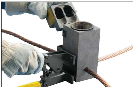
**Fig. 21** – Retirer le connecteur de boîtier de commande de la bande d'allumage. Ouvrir le couvercle et retirer le gobelet Cadweld Plus usagé du moule.
