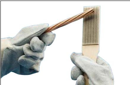
**Fig. 12** – Ensuite, utiliser une brosse métallique pour préparer davantage la surface des conducteurs et de la piquet de terre (brosse nVent ERICO T-313 ou T-314). Gratter la surface extérieure pour éliminer la saleté et l'oxydation. Vous remarquerez un léger changement de couleur.
