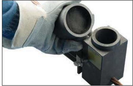
**Fig. 27** – Retirer les clips d’alligator de la goupille d’allumage. Retirer le couvercle en graphite du moule Cadweld Exolon.
