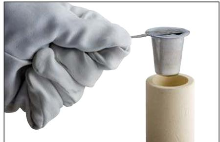
**Fig. 9** – Placer la coupelle du métal d'apport dans la partie supérieure du moule. Vérifier que la bande d'allumage s'imbrique dans le renforcement sur le bord supérieur.
