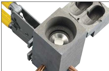
**Fig. 17** – S'assurer que le disque en acier est correctement installé.
