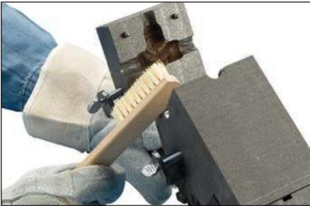
**Fig. 27** – Les moules en graphite Cadweld ont une durée d'environ 50 connexions. Utiliser un chiffon en coton doux ou une brosse à poils doux (nVent ERICO, pièce n° T394 pour nettoyer l'intérieur de la cavité et du couvercle du moule.
