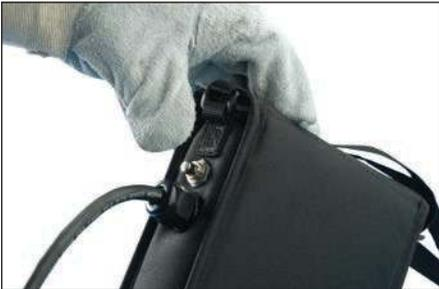
**Fig. 26** – À l’aide du bloc-batterie Cadweld Exolon, appuyer sur le bouton. À ce moment-là, l’unité enverra une charge à la goupille d’allumage. La goupille d’allumage déclenche la réaction exothermique Cadweld Exolon.
