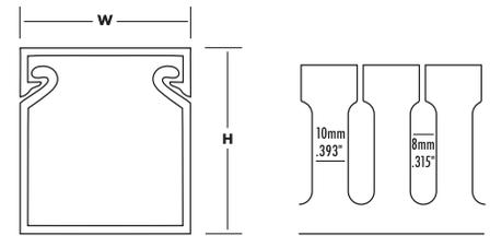
Finger width = 10 mm, slot width = 8 mm.
